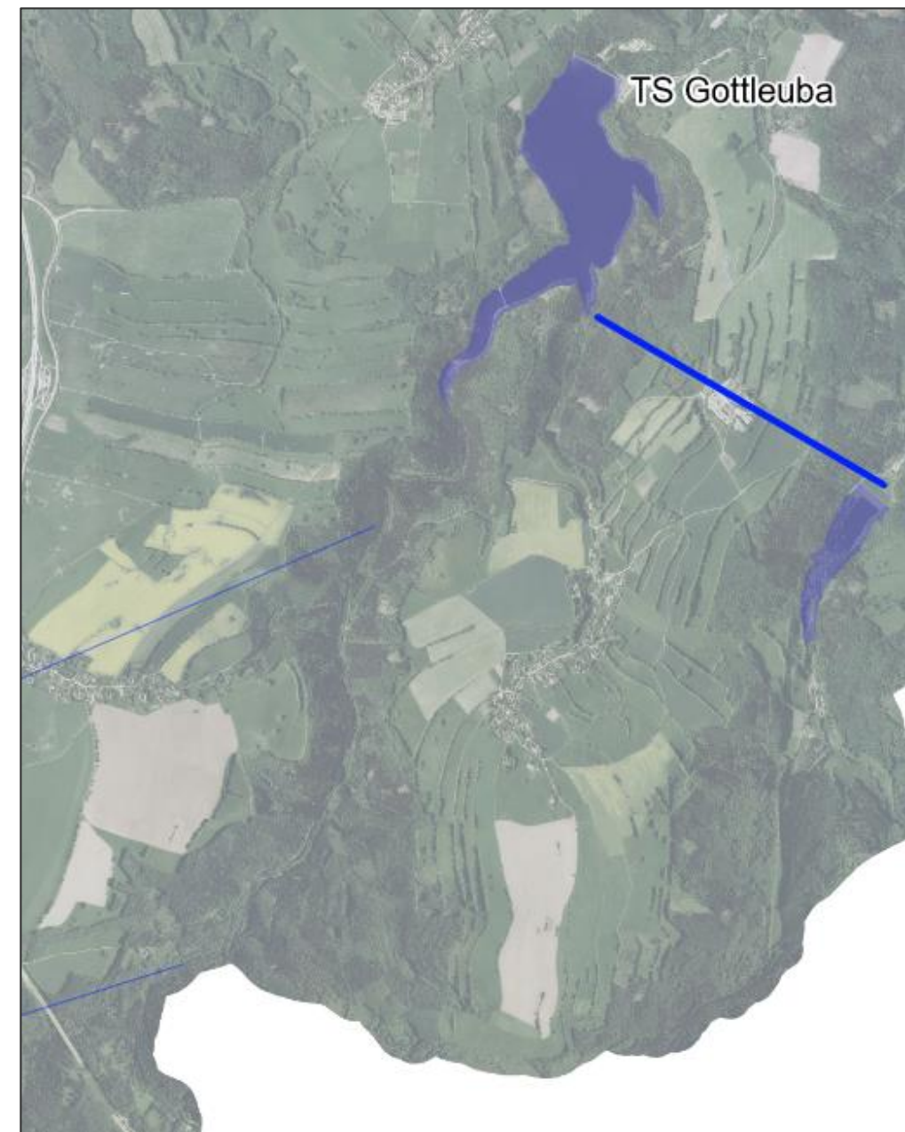
Überleitung Mordgrundbach – TS Gottleuba Trassenlänge ca. 2 km
